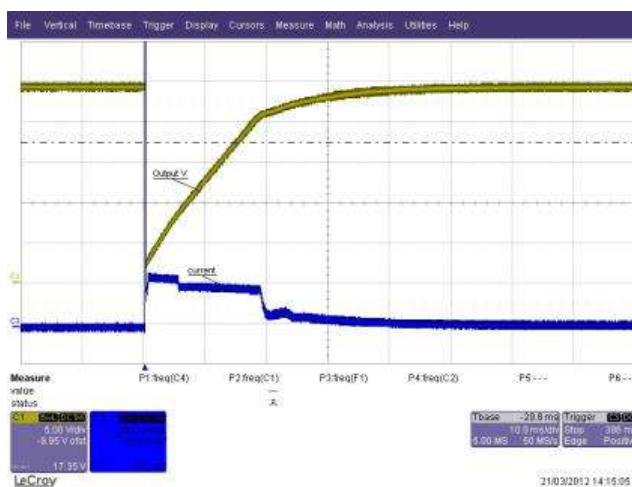
Fig. 3 : La CFE400M peut fonctionner à 300 W avec un condensateur de 3 000 \mu F commuté sous tension et maintenir sa tension de sortie sans passer en mode « hiccup ».
