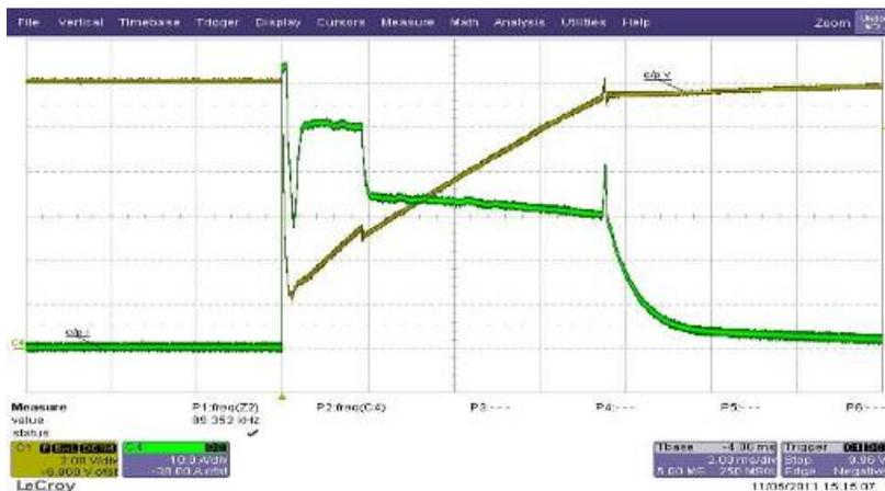
Abb. 3: Das CFE400M kann bei 300 W Belastung einen zusätzlich zugeschalteten Kondensator mit 3000  $\mu\text{F}$  aufladen und erholt sich dabei, ohne in den Hiccup-Modus zu wechseln.
