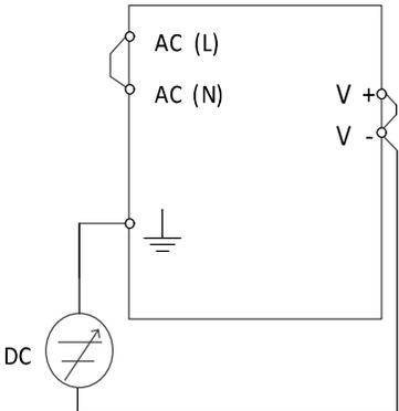
**6-11. Withstand Voltage Test**
