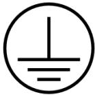
Schutzleiterklemme. Dies ist die Klemme, die für den Anschluss an einen externen Leiter zum Schutz gegen elektrischen Schlag im Falle eines Fehlers vorgesehen ist.
