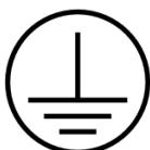
Terminal conductor de protección. Este es el terminal que está designado para la conexión de un conductor externo para protección contra descargas eléctricas en caso de falla.
