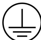
Borne du conducteur de protection. Il s'agit de la borne destinée au raccordement à un conducteur externe pour la protection contre les chocs électriques en cas de défaillance.
