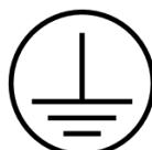
Terminal condutor de proteção. Este é o terminal destinado a ser conectado a um condutor externo, para proteção contra choques elétricos em caso de uma falha.
