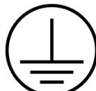
Terminale conduttore protettivo. Questo è il terminale che è destinato al collegamento a un conduttore esterno per protezione contro scossa elettrica in caso di guasto.
