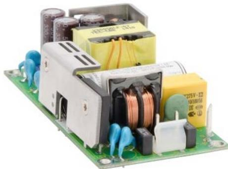
Das 100 W Netzteil ZMS 100 von TDK-Lambda weist dank ausgefeiltem Thermodesign eine Lebensdauer von über 10 Jahren (bei 230 Vac, 75% Last und Luftkonvektion) auf.
