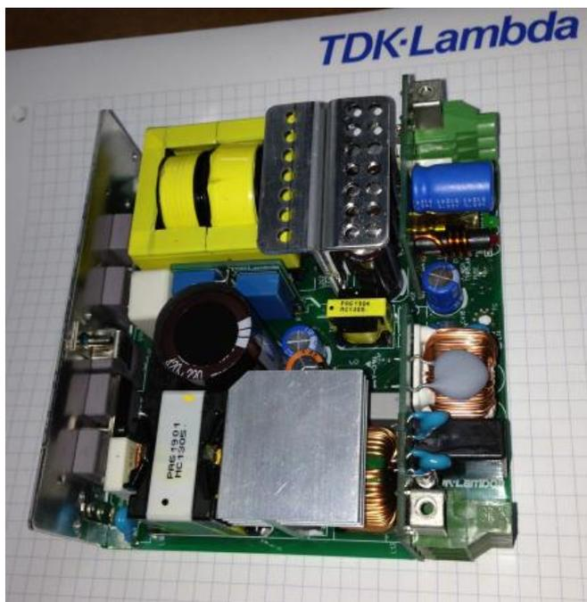
Bild 5: Das thermisch anspruchsvolle DRF Design wird gerade ausgiebigen, finalen Testreihen unterzogen. Es kommt trotz leistungsstarker Daten mit wenig Platinen, Komponenten und Verbindungselementen aus. Das bringt Vorteile bei der Produktion, beim Testen/Prüfen und bei der Langlebigkeit. Für die TDK-Lambda DRF selbstverständlich: eCap-Lifetime-Werte > 5 Jahre.
