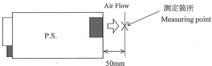
Fig. 1 ファン排気温度測定箇所
